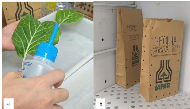
Figura 4 - Folhas de couve enxaguadas com água deionizada (a) e acondicionadas em saco de papel perfurados, acomodados na estufa com circulação forçada de ar a 65^\circ\text{C} (b). Londrina, PR. 2023.
